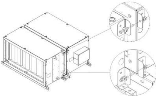
Универсальность ПУ определяется возможностью организации стороны обслуживания с правой или левой стороны, путем взаимной замены верхней и нижней панелей установки. Монтаж установки должен обеспечивать минимально необходимые требования к доступу для проведения технических и обслуживающих мероприятий:
