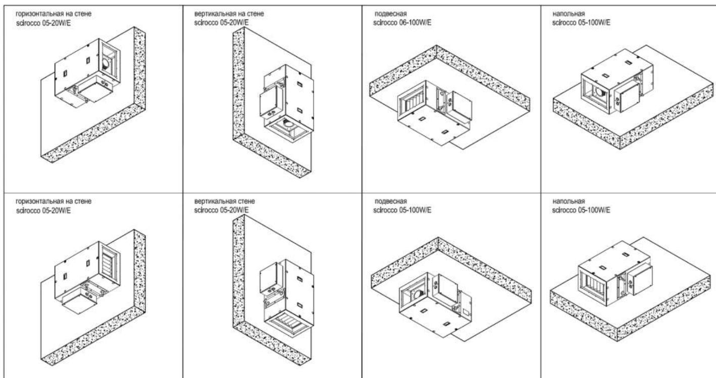
ПУ может быть установлена в любой пространственной ориентации (напольной, подвесной или настенной) согласно приведенной выше схемы. Монтаж ПУ Scirocco 07-60/W должен обеспечивать возможность слива воды. Не допускается монтаж ПУ Scirocco 07-60/W вверх выходными патрубками. Места и материалы поверхностей, на которые производится крепление ПУ, должны удовлетворять требованиям максимальной нагрузки. Крепление ПУ должно осуществляться с использованием виброизолирующих опор или подвесов.
