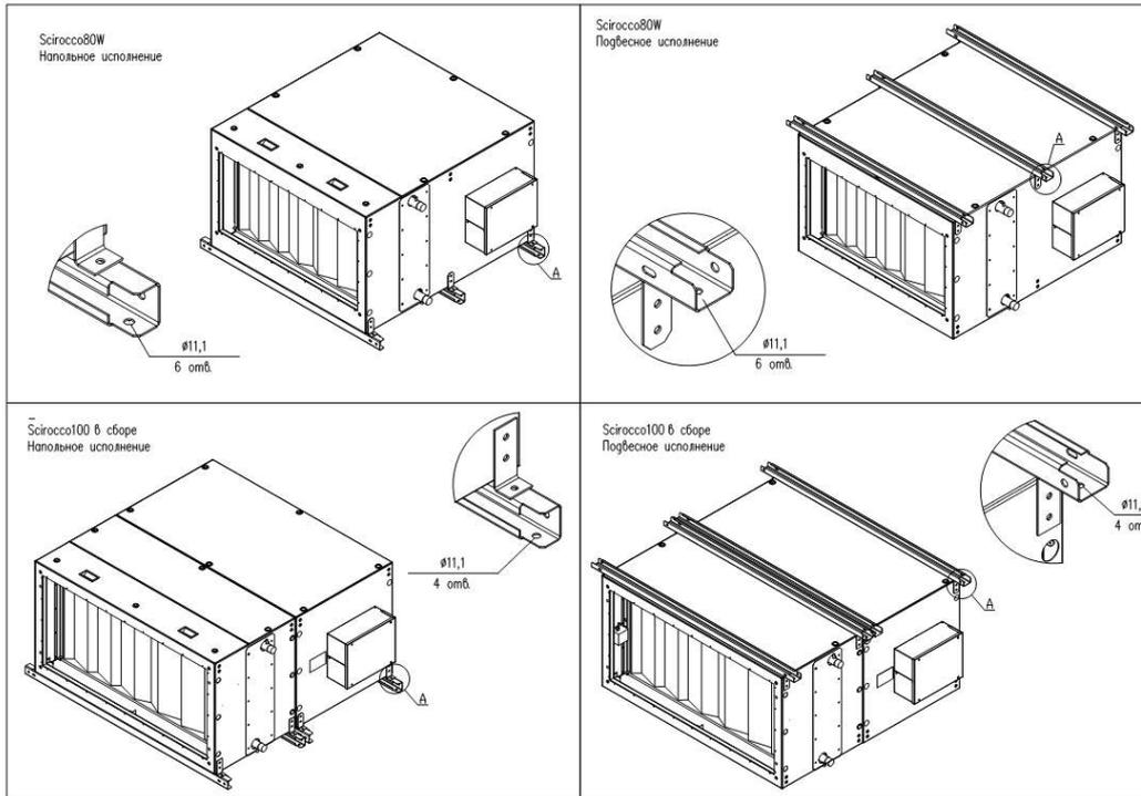
Без применение данных траверс монтаж установок не допускается.
