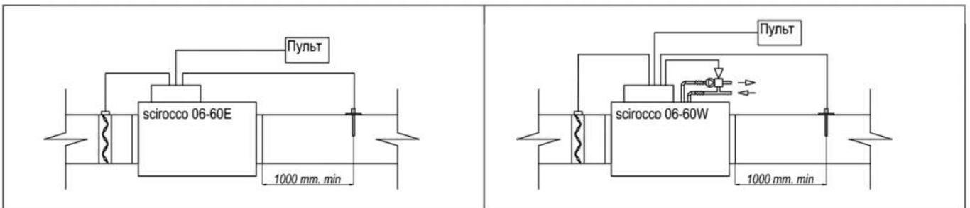
В качестве датчика канальной температуры применяются только NTC 10k. ( в комплекте поставки)
