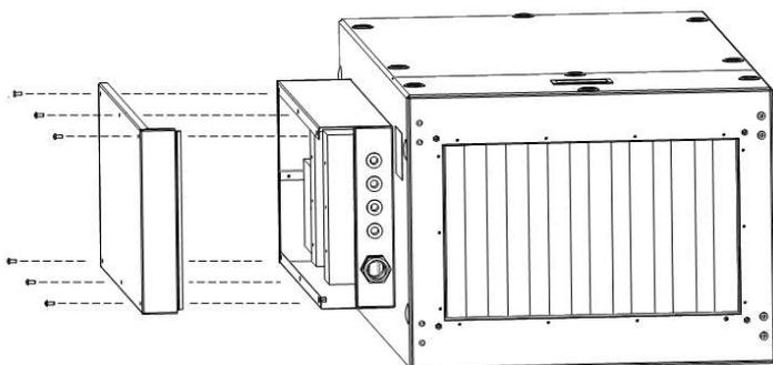
Для подключения дополнительных датчиков комплектующих и органов управления необходимо открыть винты на боксе автоматики и снять его крышку.
