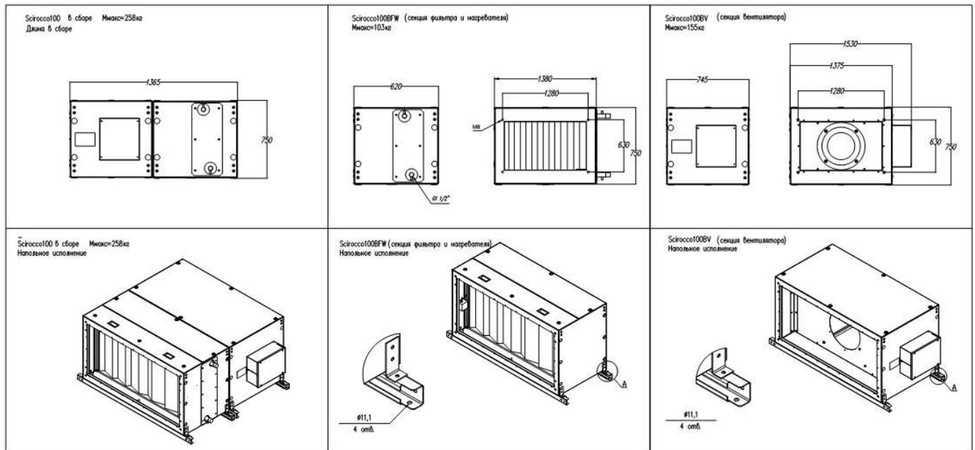
Сопряжение двух секций осуществляется с помощью монтажных скоб (в комплекте поставки)
