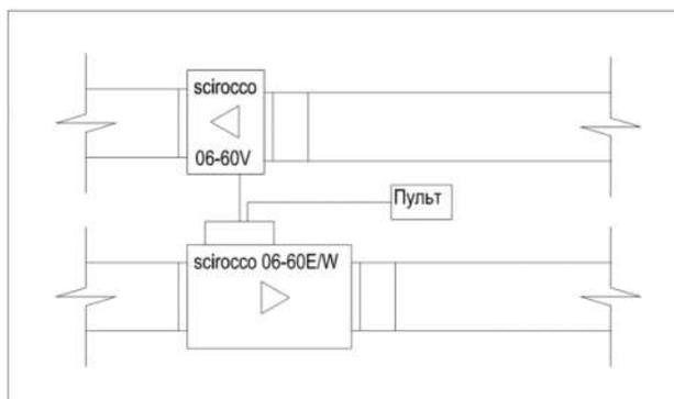
Автоматика ПУ обеспечивает возможность подключения секции вытяжного вентилятора Scirocco05-125V либо любого другого вентилятора соответствующего номинала. Управление вытяжной секцией ведется автоматикой приточной установки с выносного пульта управления.
