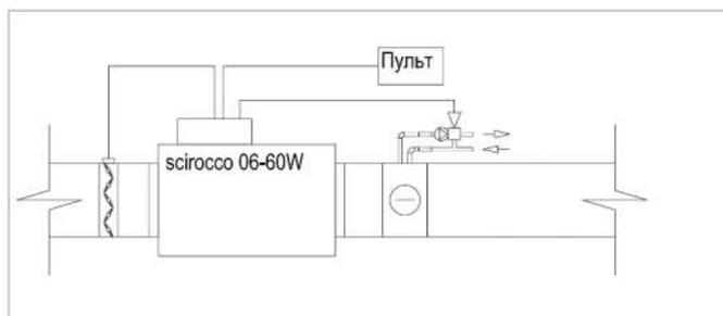
При использовании дополнительной секции охлаждения необходимо обеспечить мероприятия для отвода конденсата.
